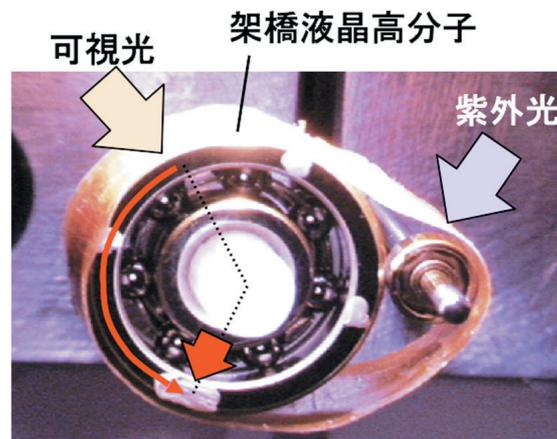
図2 光プラスチックモーターの写真
